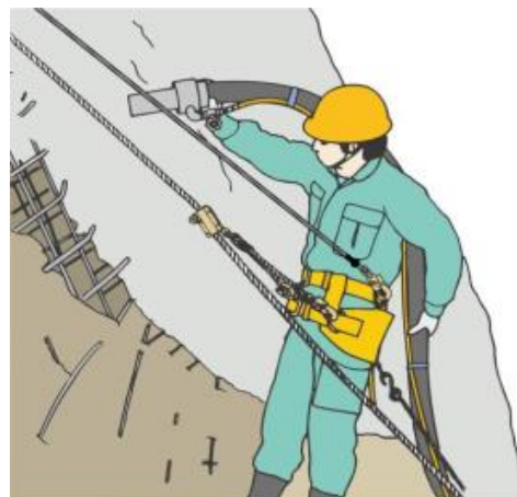
のり面保護作業
