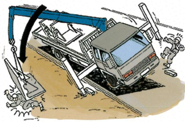
軟弱地盤や傾斜のある場所での作業は避けましょう。必要により、地盤部に補強・養生を行うこと。転倒事故の4割はアウトリガの沈下が原因。
